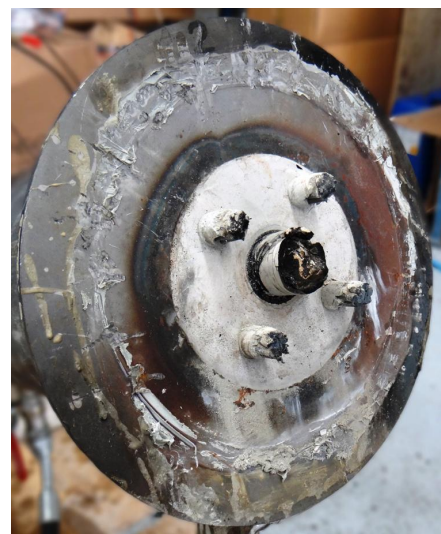
Cementazione di sigillatura a piastra rimossa
