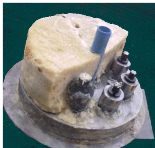
CAP protezione SERIE BASSA – riempimento con resina poliuretana espansa
