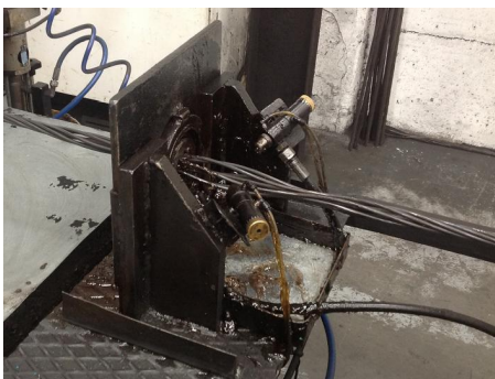
Fase pre-ingrassatura del trefolo e viplatura del medesimo
