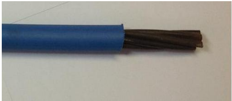
Fase pre-ingrassatura del trefolo e viplatura del medesimo
