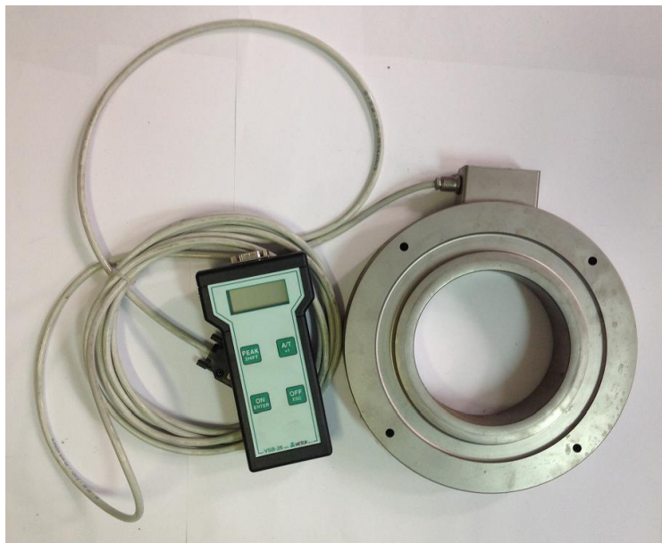
Cella di carico per rilievo stato tensionamento tiranti (lettura a distanza tramite centralina digitale palmare e cavo elettrico di collegamento)
