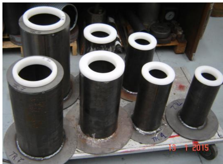
Dispositivi protezione sottopiastra (rif. scheda Tecnica ST.05.B)
