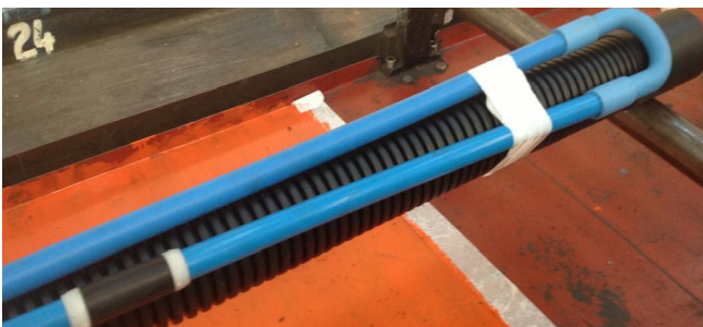
Assemblaggio con tubo valvolato A/R \varnothing = 15 \times 21 \geq \text{ mm}
