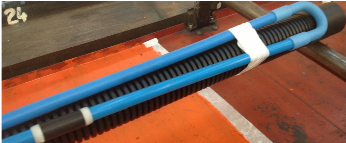
Assemblaggio con tubo valvolato A/R [ \varnothing = 15 \times 21 \geq mm
